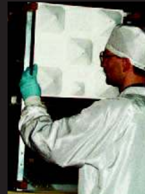
2002, Project manager Dr. Felix Huber is mounting the GTS transmission antenna Projektleiter Dr. Felix Huber bei der Montage der GTS Sendeantenne
