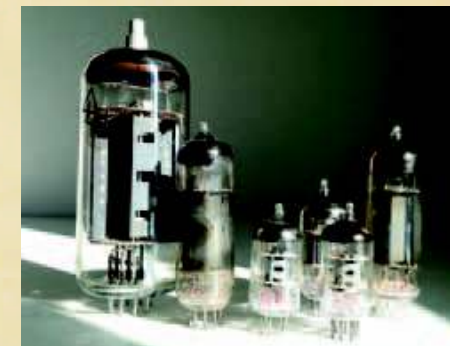
Electronic tubes, the first components of electronics Elektronenröhren, die ersten Bauelemente der Elektronik
